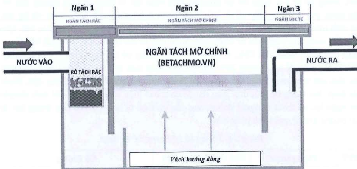
Hình 16. Cấu tạo bể tách dầu mỡ
