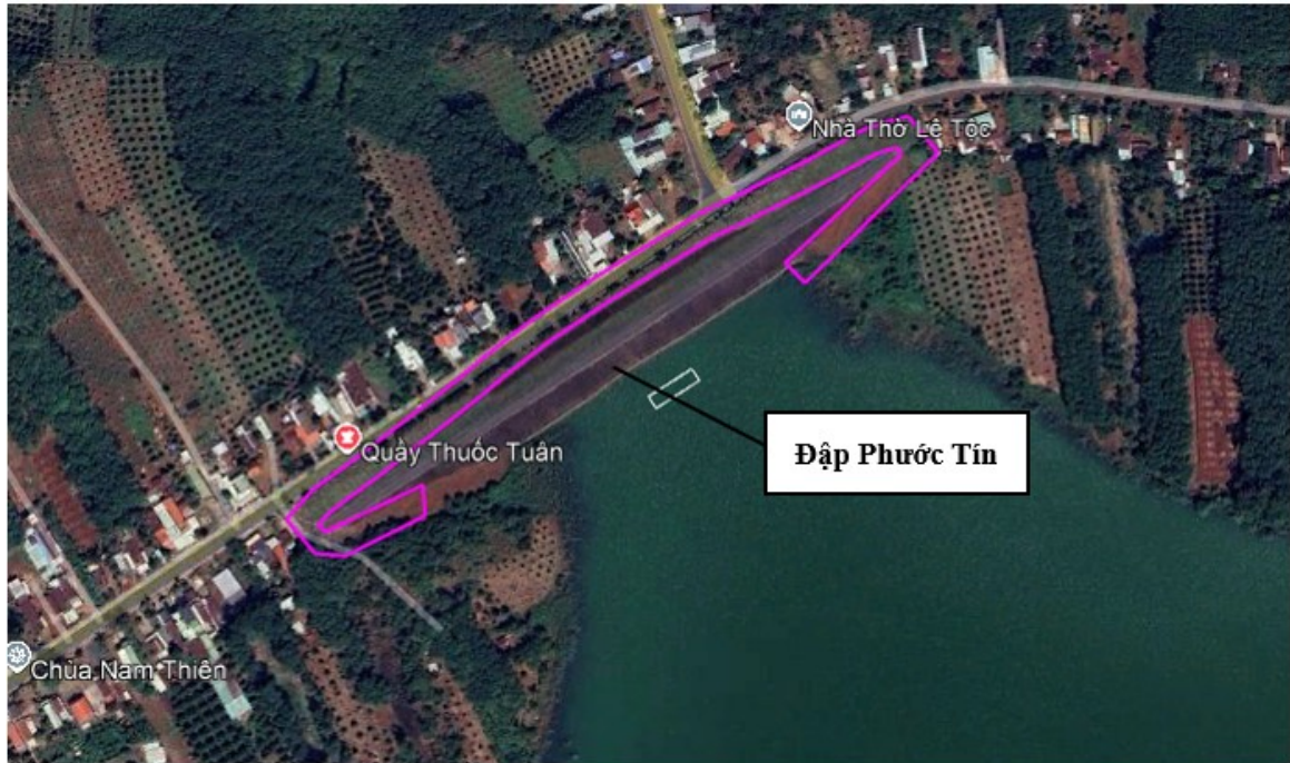
Hình 2.9: Phạm vi cấm mốc hành lang bảo vệ đập Phước Tín, khoảng cách 20m từ chân đập. Xây dựng hàng rào lưới sắt xung quanh đường biên + công sắt khóa.
