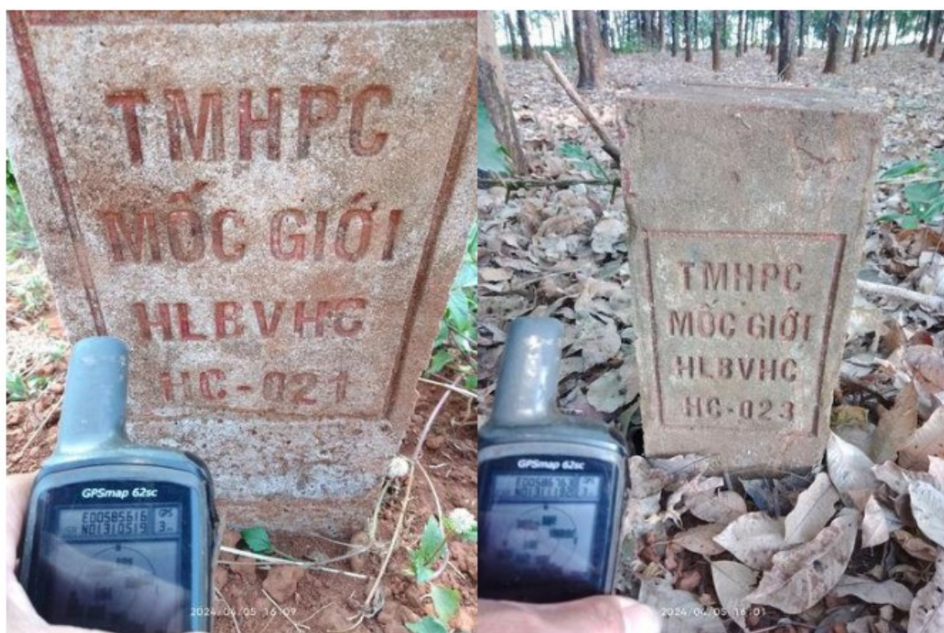
Hình 2.2: Quy cách mốc hành lang bảo vệ hồ chứa
